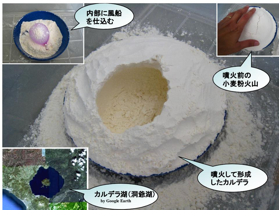
小麦粉でつくった山の中に小型風船を仕込み、風船が割れるまで空気入れて膨らませて爆発させ、火山噴火とカルデラ形成のモデル実験を行う。または、膨らませた風船を埋め込み、針金などで割って爆発させる。小麦粉の火山を手で固めるときの加減によって、様々な形態のものをつくりだすことができる。砂場でスケールの大きい実験を行う方法もあるが、風船の上の砂が崩れ落ちてくるため、砂を適度に湿らせる必要がある。
