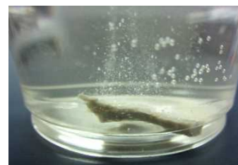
Fig.9 食酢で発泡する石灰岩
