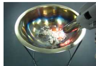
Fig. 5 石灰岩の強熱
