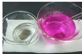
Fig. 6 加熱後に水に入れると強塩基性を示す（右）
