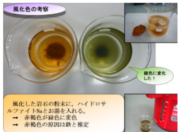
図3 風化岩の還元処理
