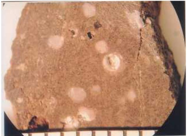
Fig.11 東和コンプレックスの緑色岩中の発泡孔。方解石や石英で充填されている。スケールの1目盛は0.5mm
