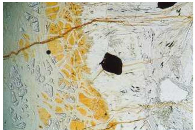
Fig.3 士別市温根別ダムの、斑れい岩と接触部の蛇紋岩 (Stop4). 写真右側 (斑れい岩側) は変質しており、透閃石が生じている。(オープンニコル, x 52).
